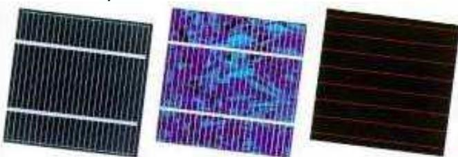
Monokristallin Polykristallin Dünnschicht/Amorph
