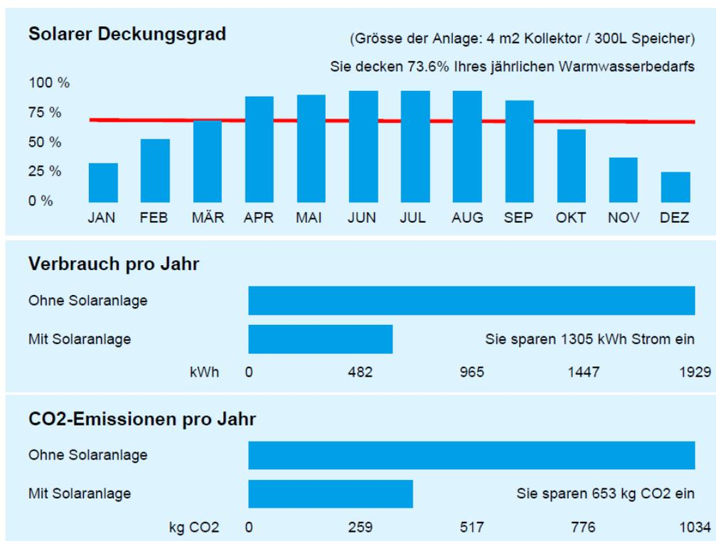
Laut des Solaren Deckungsgrads könnte man, mit Solaranlagen bis zu 1305 kWh Strom einsparen, was sich auf jeden Fall rentiert, wenn man es längerfristig nutzt. Bei nicht benützen des Hauses kann der Strom direkt ins Netz gespeist werden und die Anlage dient als Kraftwerk, was auch Geld einbringt.
