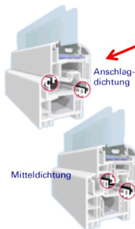
befindet sich in der Dichtungsebene zwischen Blockrahmen und Flügel. Sie kann als Außendichtung im Blockrahmen oder als Innendichtung im Fensterflügel angebracht werden.
