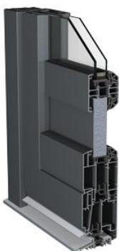
Die Dreifachdichtung ist eine Kombination aus Anschlagdichtung und Mitteldichtung. Der Vorteil liegt in weiter verbesserten Schallschutzwerten. Weitere technische Vorteile gegenüber den anderen Dichtungsarten sind nicht zu erkennen.
