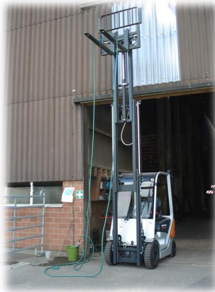
Abb. 13 Pumpentest mit Hilfe eines Hubstaplers
