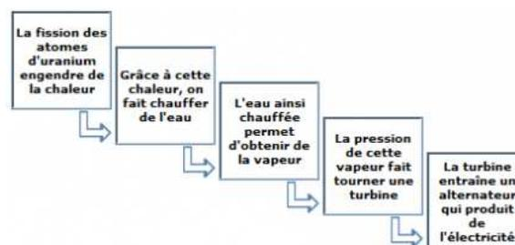
Principe de fonctionnement d'une centrale nucléaire<sup>1</sup>
