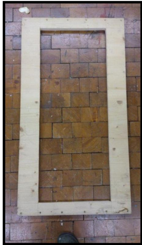
Abbildung 7: Holzrahmen zugesägt
