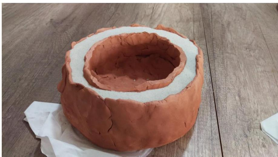
Comme avec l'expérience des pots, nous mouillons le sable et mettons un linge humide au-dessus. Nous mesurons aussi la température à l'intérieur pour voir l'évolution.
