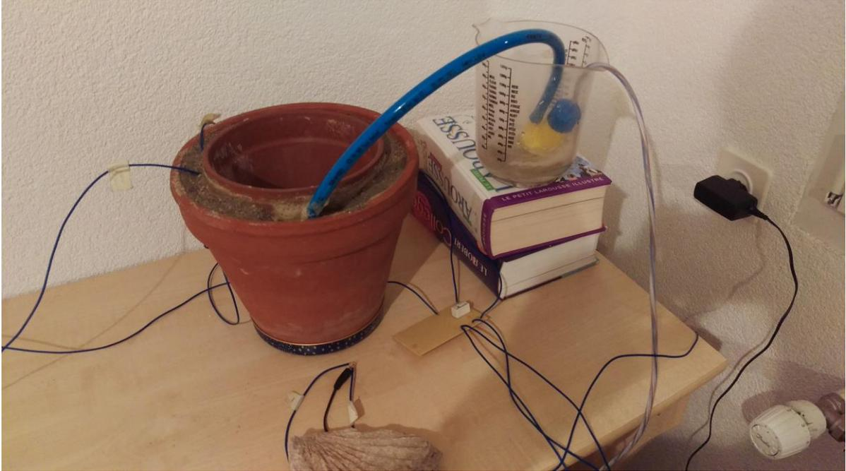
Comme les deux fils n'entrent pas en contact même dans l'eau la pompe ne s'arrête pas, il fallait soit couper l'alimentation (deux fils au bas de la photo) ou soit rejoindre les deux fils du capteur dans le pot.
