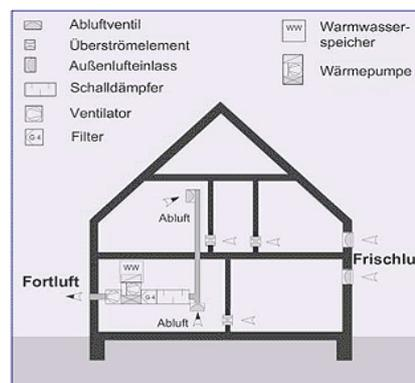
Abbildung 38: Zentrale Abluftanlage mit Wärmerückgewinnung über eine Luft-/Wasser-Wärmepumpe
