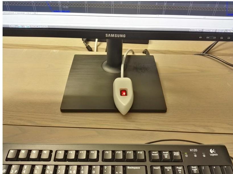
Externer Schalter für die Steckleiste am Arbeitsplatz. Damit werden am Abend alle angeschlossenen Geräte vom Netz getrennt. Die Steckleiste befindet sich unter der Tischplatte.
