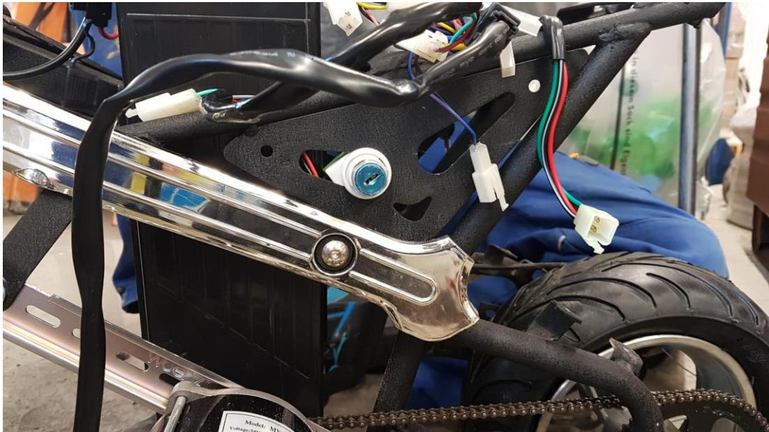
Daraufhin haben wir auf der anderen Seite das Zündschloss montiert. Jetzt kommt das Herzstück von dem Ganzen. Das ist der Akku! Der hat extrem viel Platz gebraucht. Den Anschluss mussten wir löten, damit sich die Drähte nicht lösen. Die beiden Drähte haben wir auch mit dem Steuerungsgerät verbunden.
