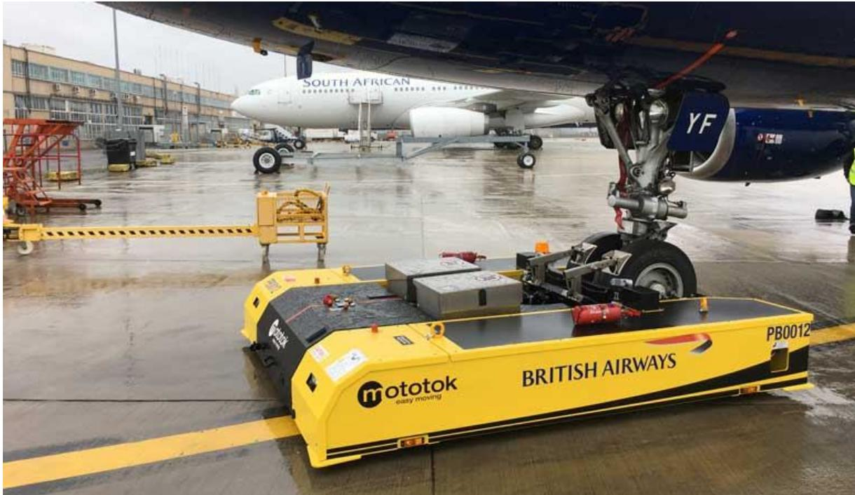
Die Firma Mototok hat ein ferngesteuertes Fahrzeug, das mit Elektromotoren betrieben ist schon im Verkauf. Dieses könnte man für den Autonomen verkehr aufrüsten. Auch bei dieser Idee müsste man in der Nähe der Startbahn ein Aufstart-Platz einplanen bei dem die Flugzeuge die so aufstarten können das sie sich selber bewegen können. Ausserdem müsste man hier auch einen Akku für die Stromversorgung des Flugzeuges einbauen.
