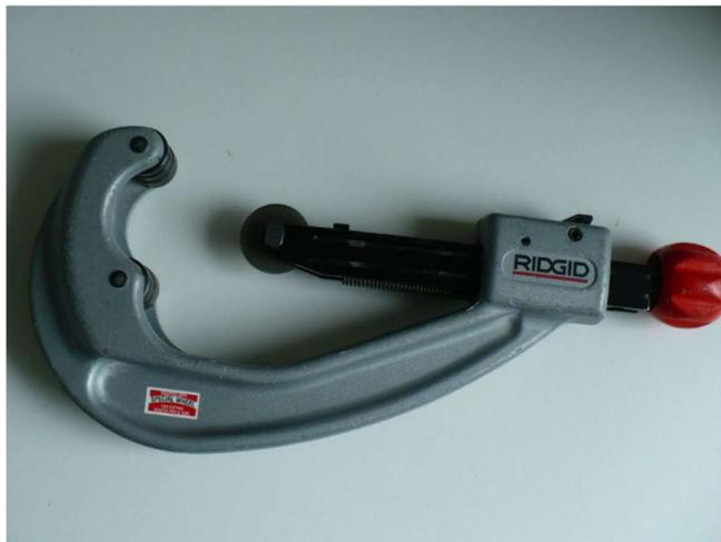
Mikka hat sie noch fertig zusammenschweisst. Dabei hat Mikka die Masse gemessen und abgeschnitten. Mikka hat die Rohre mit einem Fachüblichen Rohr Abscheider abgeschnitten. Dabei muss man nur bei dem Strich für das benötigte Mass ansetzen und danach muss man dort abschneiden.
